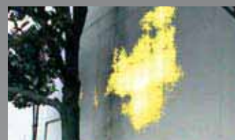
L'immagine FLIR Thermal Fusion rileva infiltrazioni d'acqua e presenza di muffa sulla parete di questo edificio.
